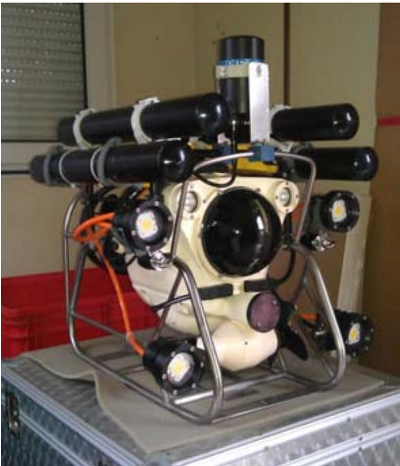
Scheinwerfer und bei Bedarf kann auch ein Greifer montiert werden. 2013 kam dann noch das Herzstück; ein 360°-Rundumsonar dazu. Das Sonar ermöglicht es, sich noch bei „null“ Sicht gut zu orientieren und Fremdobjekte, wie z.B. Wracks, gut zu erkennen (siehe Bild 2). Für das gleiche Geld was nur das Sonar kostet, könnte man auch ein Occasion-Auto kaufen, aber damit kann man leider nicht den Seegrund absuchen. Was macht man nicht alles
